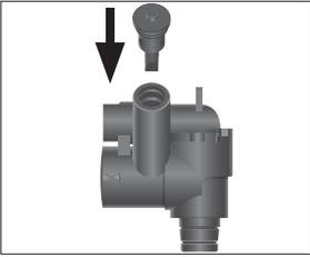
► Setzen Sie den Luftansaugstutzen ein.
